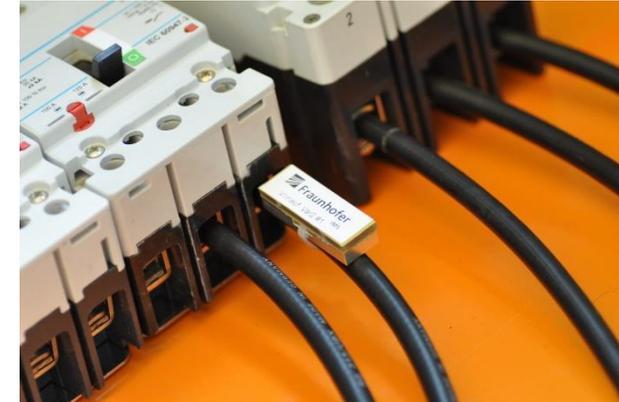
RFID-Transponder mit Temperatursensor zur Überwachung elektrischer Kontakte
